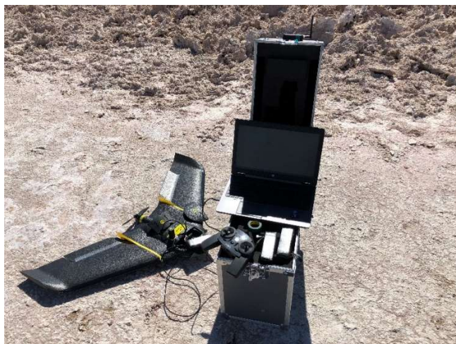
Equipo autónomo utilizado para la toma de imágenes aéreas, Ebee Plus
