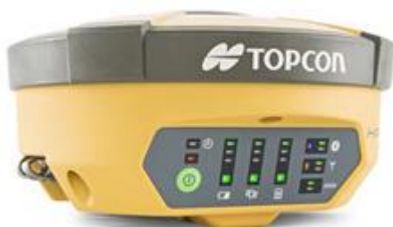
Equipo GPS marca: Topcon Modelo: Hiper V
