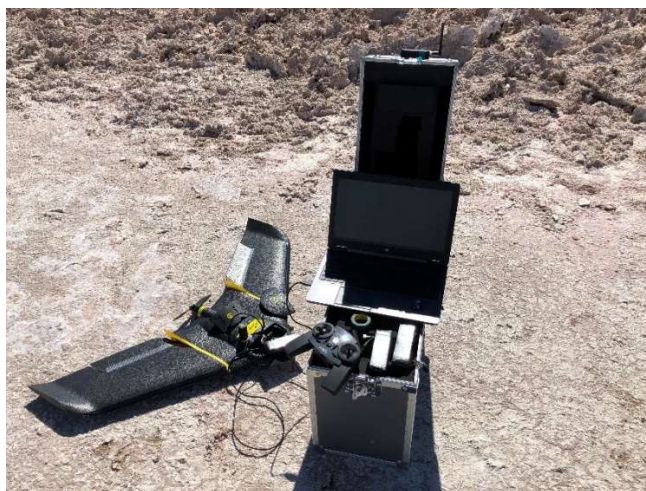
Equipo autónomo utilizado para la toma de imágenes aéreas, Ebee Plus
