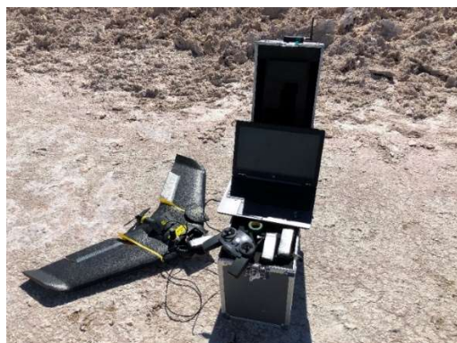
Equipo autónomo utilizado para la toma de imágenes aéreas, Ebee Plus y cámara thermoMAP
