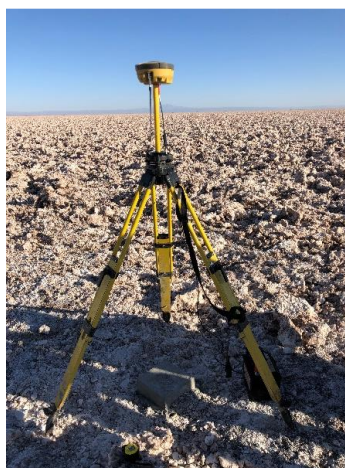
Equipo de medición GPS sobre monolito de hormigón.
