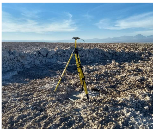
Equipo de medición GPS sobre monolito de hormigón.
