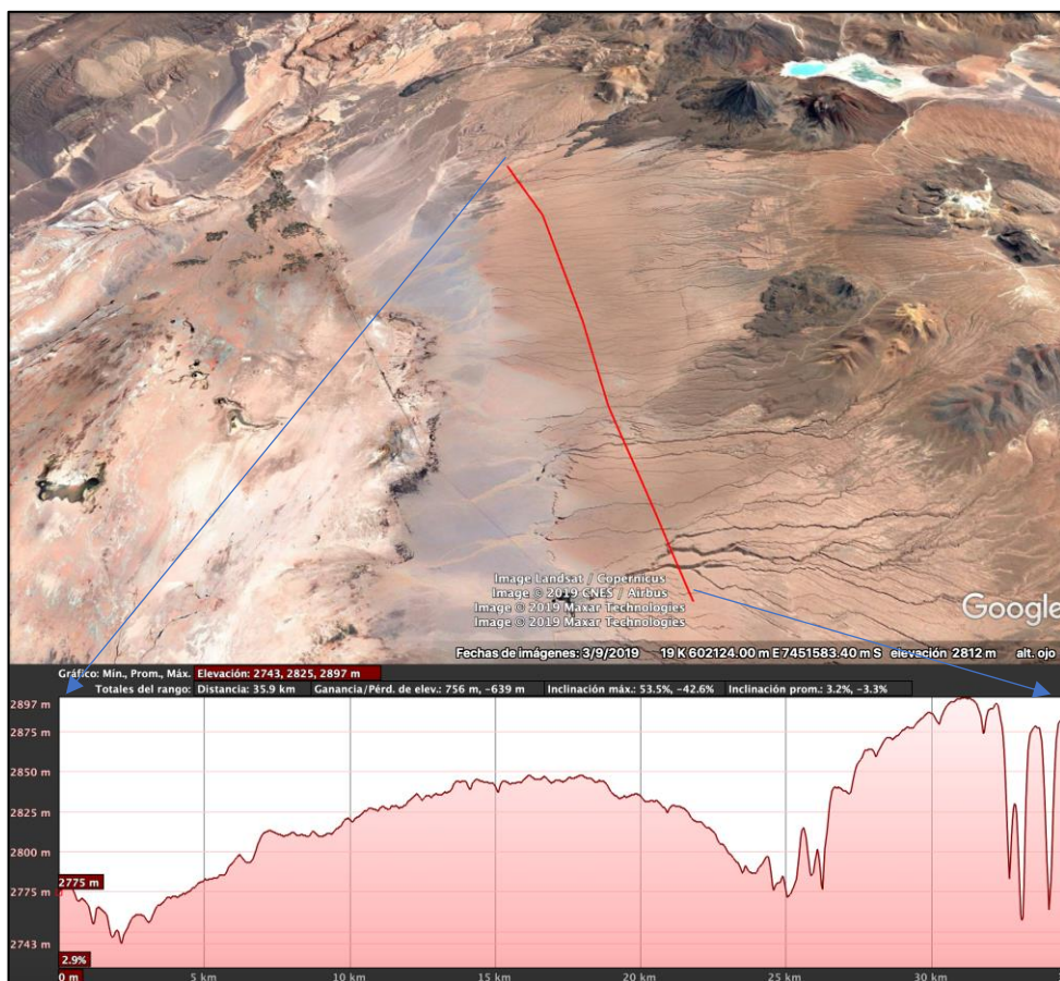
Figura I-5. Sección en el sector noreste del Salar sobre las laderas de ignimbritas erosionadas por los cauces que van en dirección hacia el salar. Fuente: Elaboración propia
