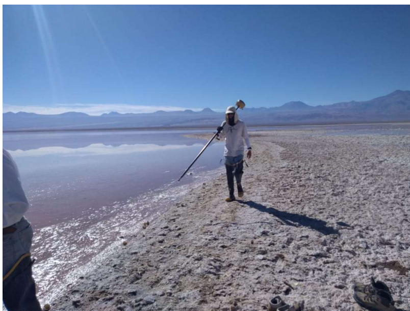
Sector de Orilla donde se toma la elevación del pelo de agua
